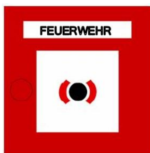
Handfeuermelder mit Aufschaltung zur Feuerwehr
