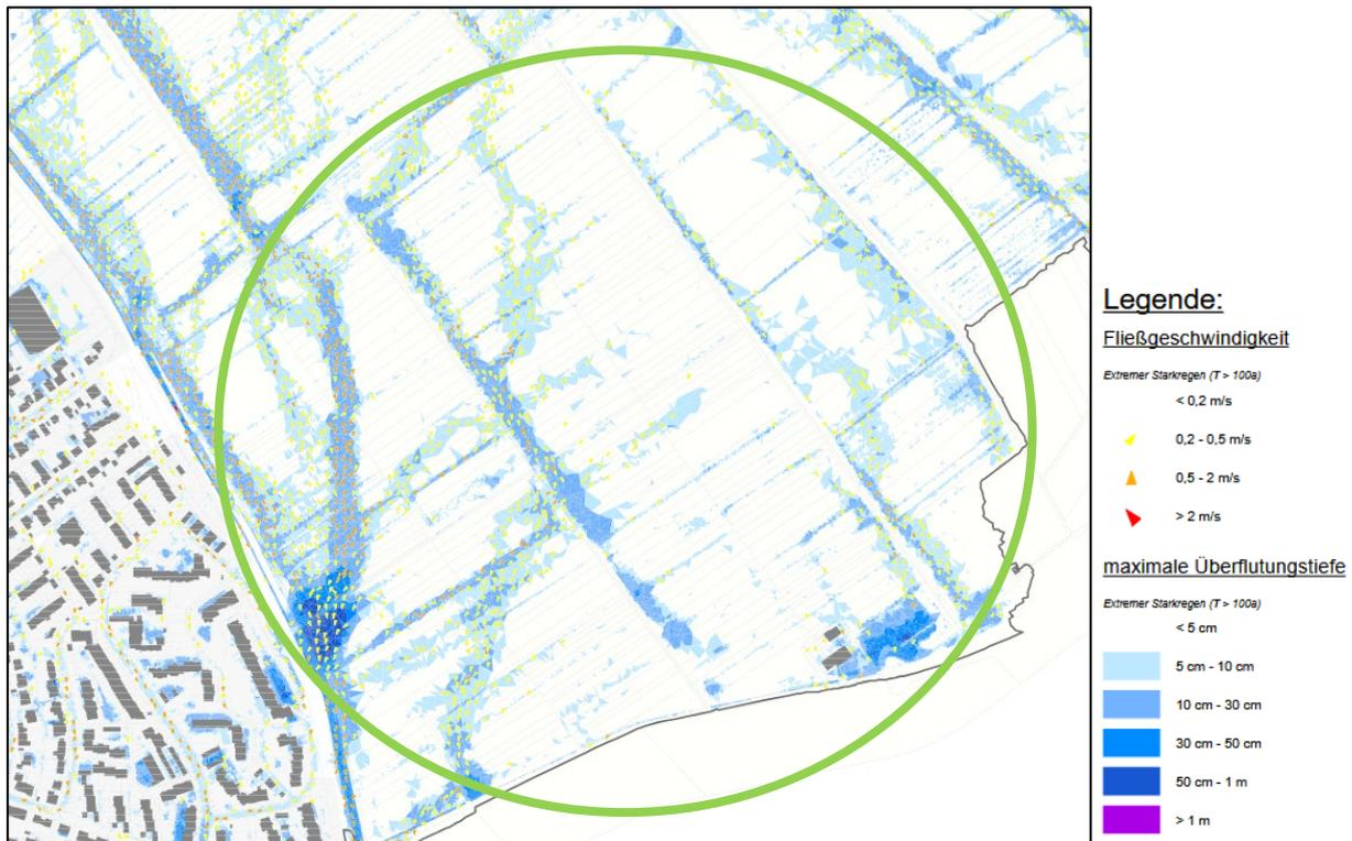
**Abb. 10: Ausschnitt Gefährdungsabschätzung infolge Starkregen (max. Wasserstand) (unmaßstäblich; Aquadrat Ingenieure GmbH, Juni 2023)**
