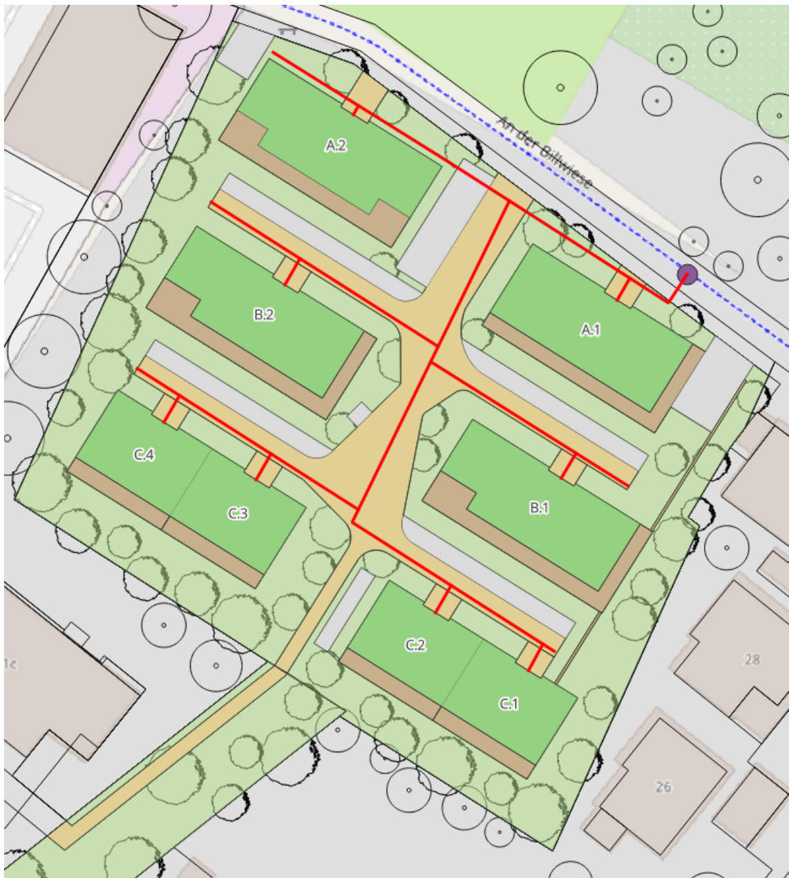
Abbildung 5-3: Vorschlag zur Verlegung der Schmutzwasserleitungen (rote Linien)
